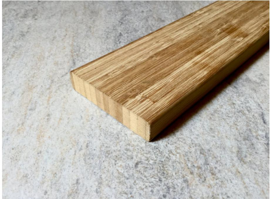
**11.** Particolare di un elemento in bambù lamellare.
